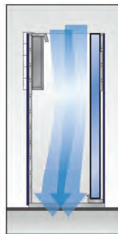
RunAir в режиме прямого естественного охлаждения
